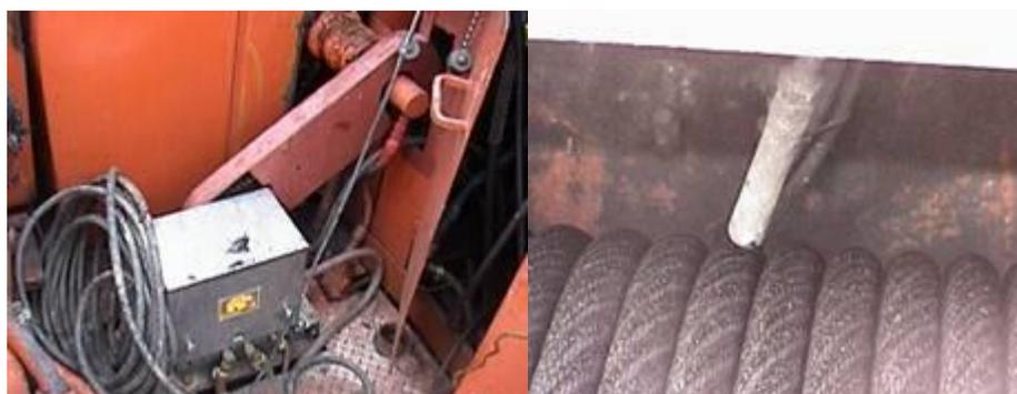
Tiene una sonda, la cual active un interruptor actuado con aire si el perforador envuelve demasiada línea de perforación en el tambor del malacate.
