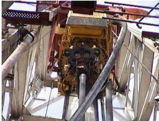
Equipo de Perforación con Sistema de Top Drive.
