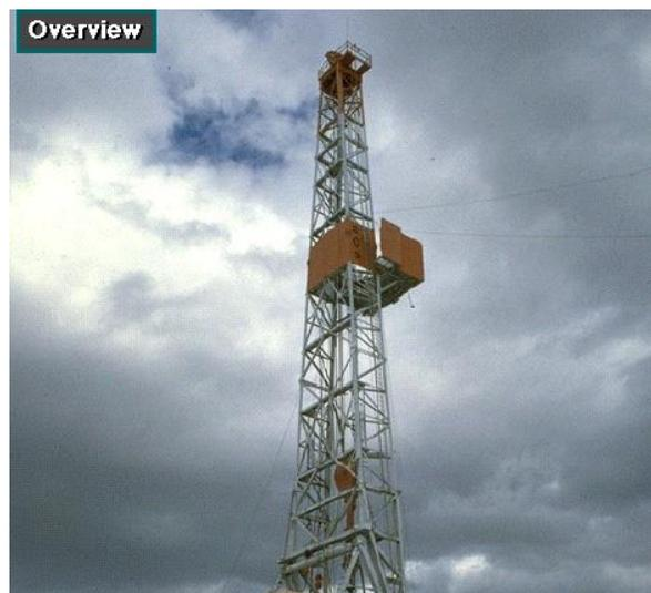
La Corona o Cornisa: Es la parte superior de la torre donde se instala un sistema de poleas fijas por donde pasan las líneas de perforación este sistema soporta la carga total sobre la torre mientras se corre la tubería.
