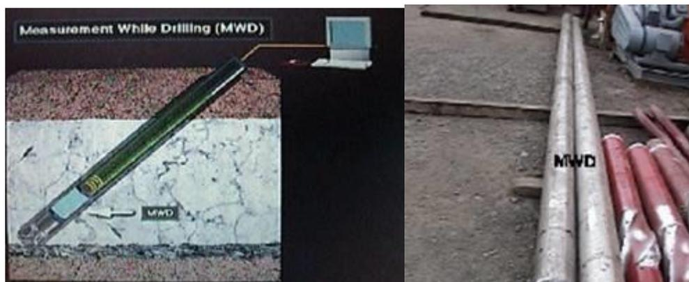
Usualmente la herramienta se coloca en un drill collar especial cerca de la broca. Las herramientas MWD registran las condiciones de fondo de pozo transmitiéndolas a la superficie. En superficie el perforador y el perforador direccional monitorean estas condiciones en tiempo real. Muchas herramientas MWD crean pulsos en el lodo de perforación. Estos pulsos llevan la información de fondo de pozo a superficie a través de la sarta de perforación. La información recolectada por el MWD incluye:
