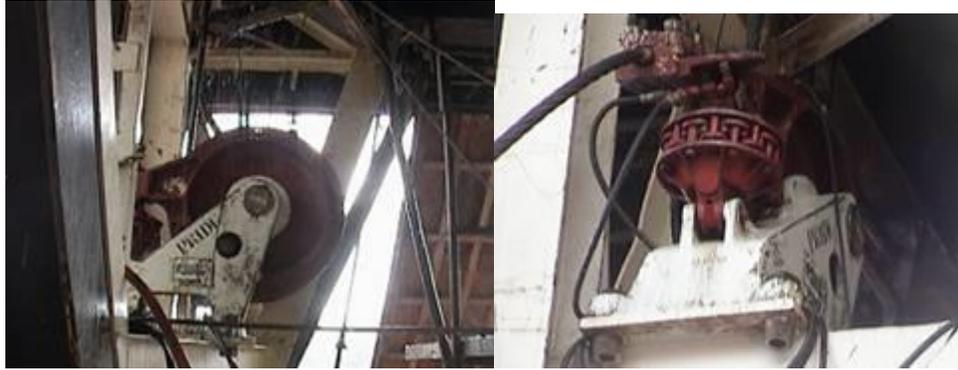
Al asegurar la línea muerta al anclaje, se aísla mecánicamente la línea de perforación del carrete de suministro. Dado que la línea no se mueve, se le llama línea muerta.
