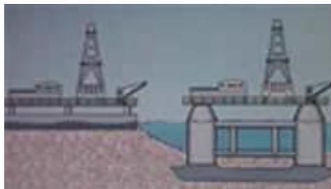
Un sumergible descansa en el fondo del océano cuando está perforando. Los miembros de la cuadrilla llenan los compartimentos con agua, esto hace que el equipo se sumerja, y sus bases descansen en el lecho marino.
