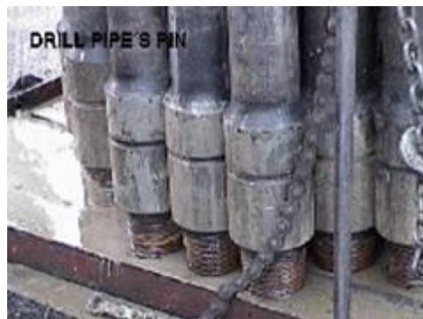
La cuadrilla de perforación conecta el drill pipe usando las roscas que se encuentran en cada extremo de la tubería, las cuales se denominan tool joints.
