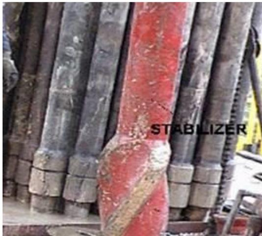
Pero ellos deben ser muy cuidadosos para no dañar estas uniones. Un manejo y cuidado apropiados del drill pipe y de otras herramientas usadas en el campo petrolero puede prevenir futuros problemas de corrosión durante la vida del pozo. La tubería debe limpiarse y ser sometida a mantenimiento regularmente. Usualmente se lleva a cabo una inspección de luz negra usando partículas magnéticas húmedas y AC Joke, cada seis meses.
