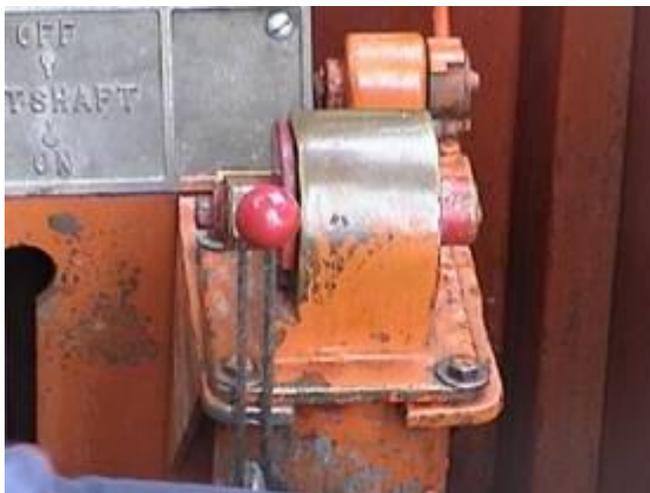
Controla la velocidad de la carga a medida que ésta va bajando. El perforador no puede controlar la baja velocidad sólo con el freno del tambor. El peso de la carga mas la fuerza creada por el movimiento es demasiado grande. Por ello, el perforador activa el freno electrodinámico. El proporciona la mayor parte de la fuerza de frenado mientras el tambor está girando.
