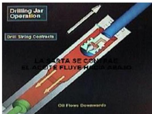
Para crear un golpe hacia arriba con el martillo, el perforador baja la sarta para preparar el martillo, después aplica tensión hacia arriba “overpull tension”, el overpull coloca el martillo superior en tensión, y permite que el mecanismo del martillo fluya lentamente. El martillo viaja cuando el
