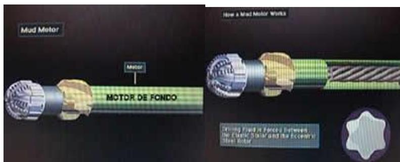
Frecuentemente, cuando se perfora un pozo horizontal o direccional, se coloca un motor de fondo en la parte inferior de la sarta de perforación, justo arriba de la broca, como se muestra al lado. Se le llama motor de fondo o motor de lodo “mud motor” porque el lodo de perforación hace rotar la broca, es decir, cuando se usa un motor de fondo únicamente rota la broca, y no el resto de la sarta.
