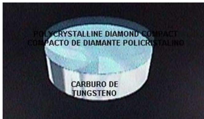
La parte de Carburo de Tungsteno le da al compacto de PDC alta resistencia al impacto, reforzando las propiedades de resistencia al desgaste de los cortadores.
