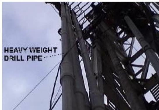
El Heavy Weight Drill Pipe tiene paredes más gruesas y tool joints más largas que el drill pipe. También tiene un wear pad en el centro del cuerpo para disminuir el contacto con las paredes del pozo
