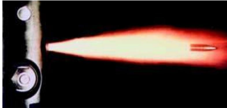
Son balas disparadas hacia el revestidor para penetrarlo junto con el cemento y la formación, es un método que pierde eficiencia a medida que la formación tenga mayor dureza y, en cementos y tuberías muy resistentes.
