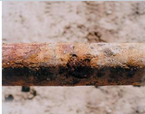
Figura 44 Corrosión de la tubería
