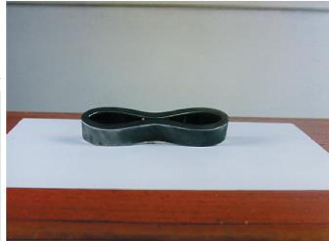
Figura 45 Muestra de una tubería colapsada
